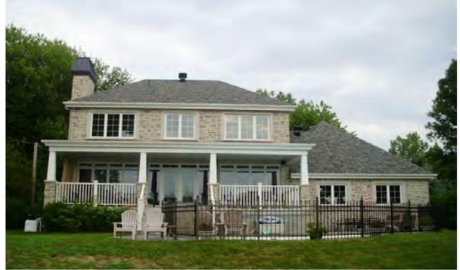
Photo 49: Vue arrière d'une résidence en bordure de la rivière dont le mur arrière fait l'objet d'un traitement architectural comme celui d'une façade principale (cheminée ornementée d'un revêtement d'acier, grande fenestration, matériau de pierre, colonnes, etc.).
